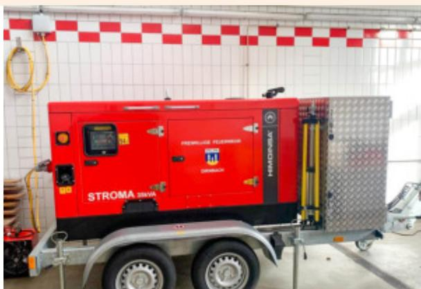
▲ Mobiles Notstromaggregat der FF Dirnbach
